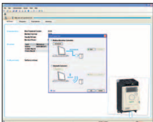
Anschlussbeispiel: Software SoMove und Frequenzumrichter ATV 12
