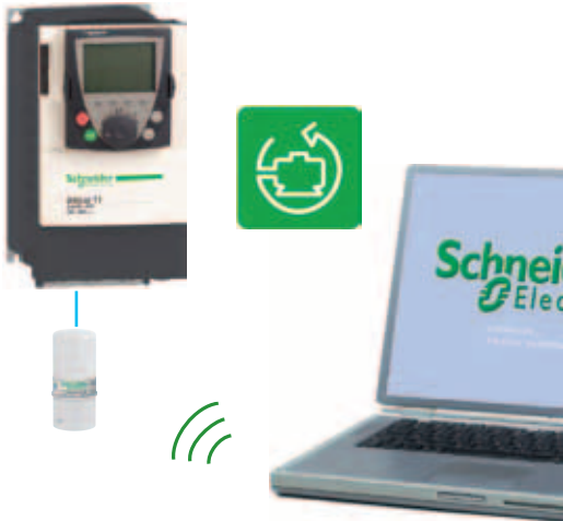
Inbetriebnahmesoftware SoMove für PC mit Modbus-Bluetooth®-Adapter
