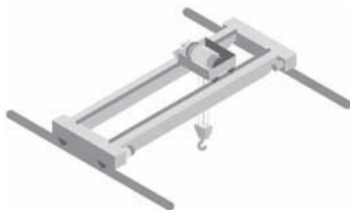
Maschine mit CANopen-Architektur: - Hebebewegung: Altivar 71 - Translationsbewegung: Altivar 312 - Laufbewegung: Altivar 312
