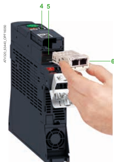
Beispiel für die Montage eines Kommunikationsmoduls 6 (Ansicht der Unterseite) an einem Umrichter in Buchbauform
