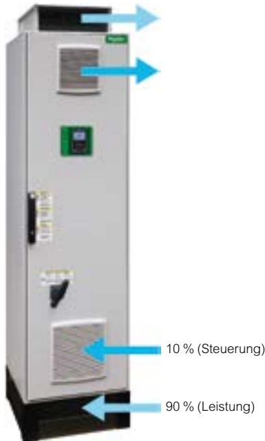
Kühlsystem mit 2 separaten Luftströmen
