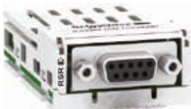
VW3A3423 Schnittstellenmodul für Encoder mit Istwertrückführung
