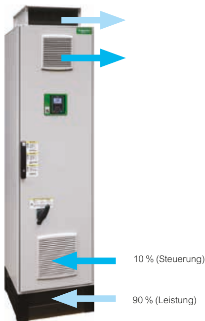
Kühlsystem mit 2 separaten Luftströmen
